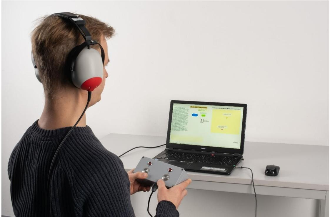
Abbildung 9. Ansicht des Prüfsystems „StraLa-GS Kopfhörer“ im Einsatz (Direktschallfeldverfahren zur Prüfung von Stöpsel-Gehörschutz).
