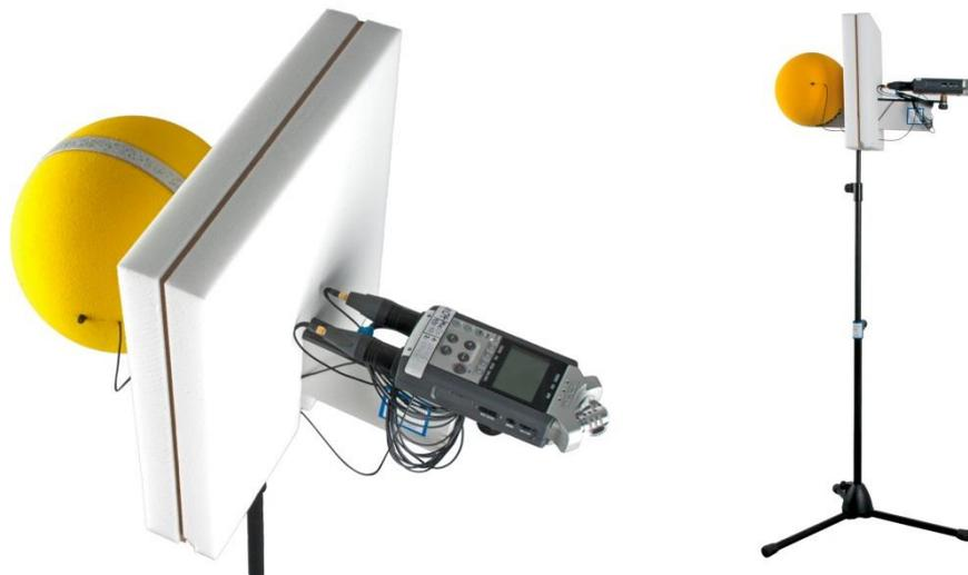
Abbildung 1. Ansicht des OSS-Aufnahmesystems auf Stativ, bestehend aus Wave-Recorder, Kopfnachbildung (gelb) aus offenporigem Schaumstoff mit akustischer Trennscheibe und zwei kalibrierten Elektret-Mikrofonen mit Kugelcharakteristik im Ohrabstand von 18 cm sowie einer rückwärtigen Reflexionsfläche (weiß) mit Absorptionsauflage aus Melaminharzschaum (wird nur bei Messungen in geschlossenen Räumen benötigt, im aktuellen Projekt nicht verwendet).
