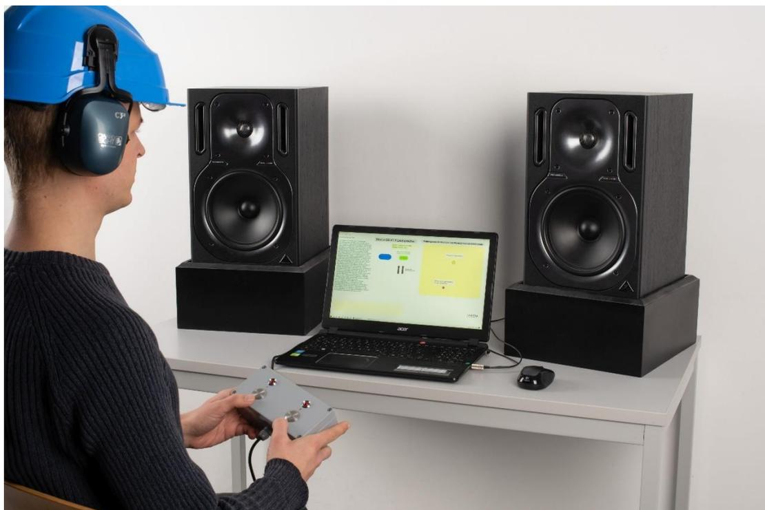
Abbildung 8. Ansicht des Prüfsystems „StraLa-GS Lautsprecher“ im Einsatz (Freifeldverfahren zur Prüfung von Kapsel-Gehörschutz).
