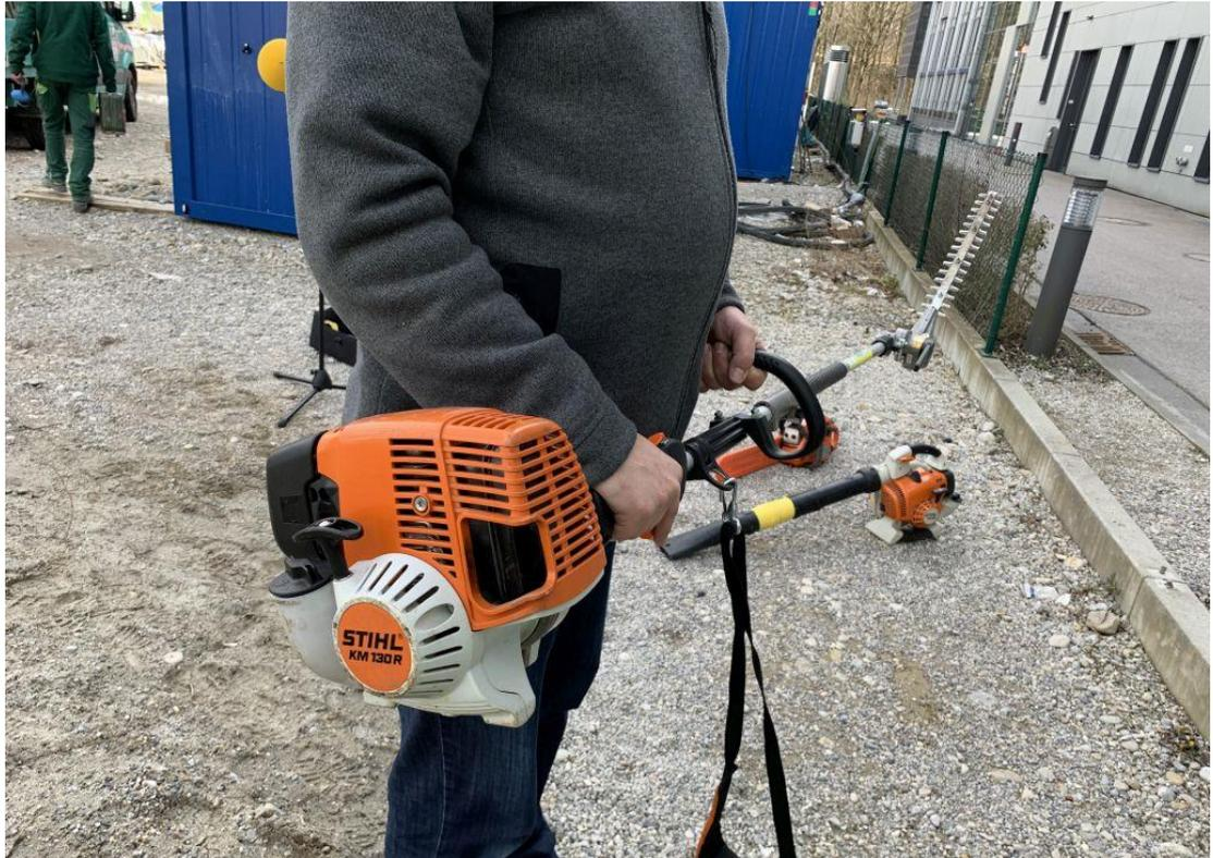
Abbildung A 3. Hochentaster/Motorsense Stihl KM130R, Schallquelle Nr. 9.
