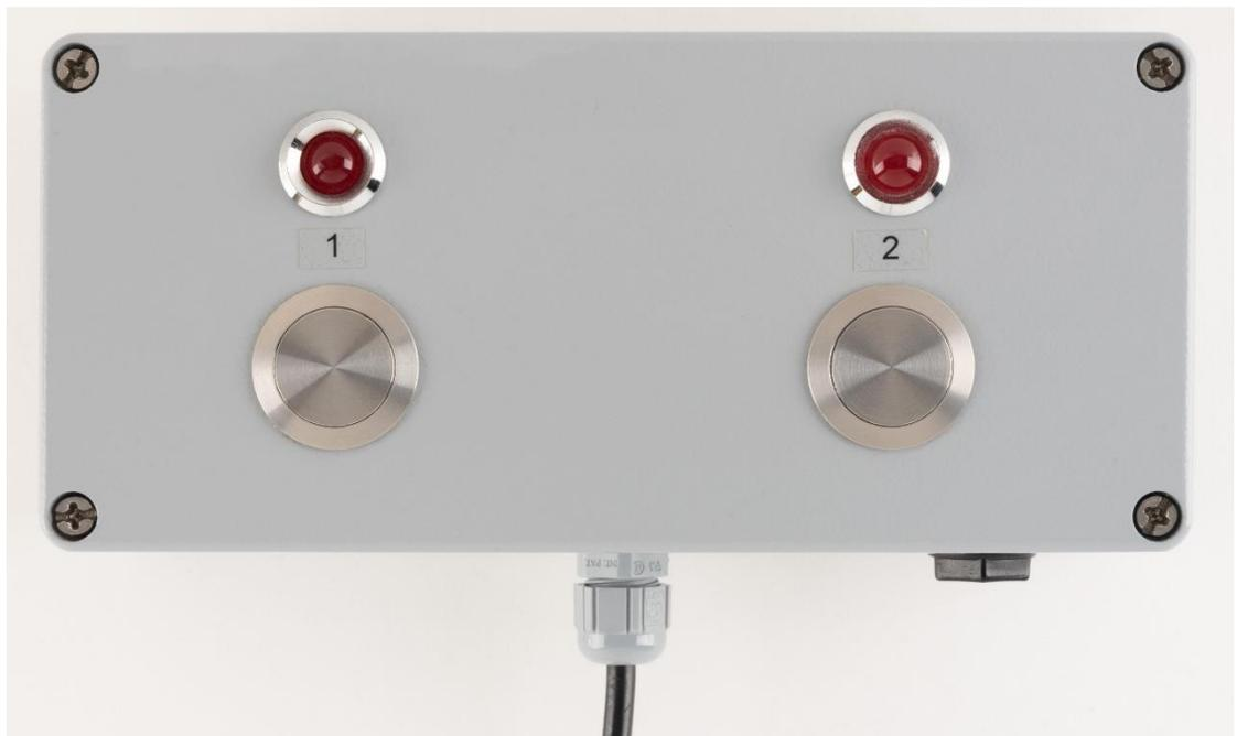
Abbildung 2. Antwortgerät (Probanden-Interface), mit dem der Proband/die Probandin während des Hörversuchs nach der Schallpräsentation angibt, ob er das Warnsignal im ersten oder im zweiten Darbietungsintervall gehört hat. Die Lampen leuchten während der Schalldarbietung im ersten bzw. zweiten Intervall. Im Antwortgerät ist außerdem der Wiedergabeverstärker für die Kopfhörer integriert.
