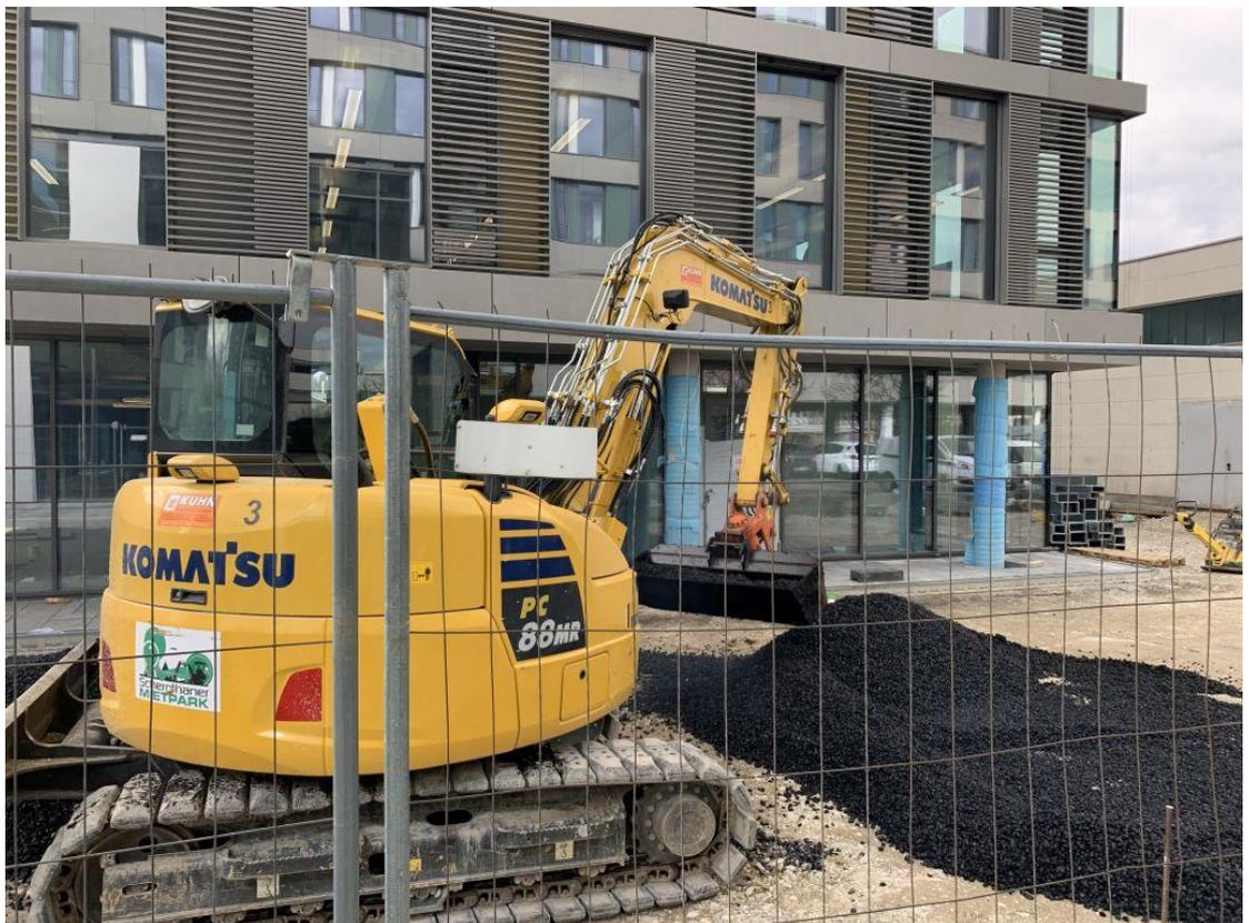
Abbildung A 2. Bagger Komatsu PC88MR, Schallquelle Nr. 7.
