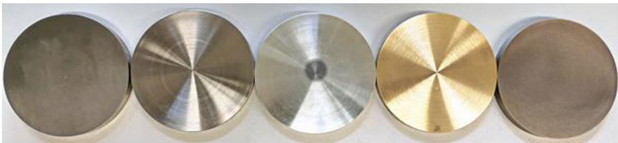
*Abbildung 30. Vorbereitete Schweißproben mit Durchmesser 70 mm und Dicke 10 mm; Werkstoffe Baustahl, nichtrostender Stahl, Aluminium, Messing und Titan (von links).*
