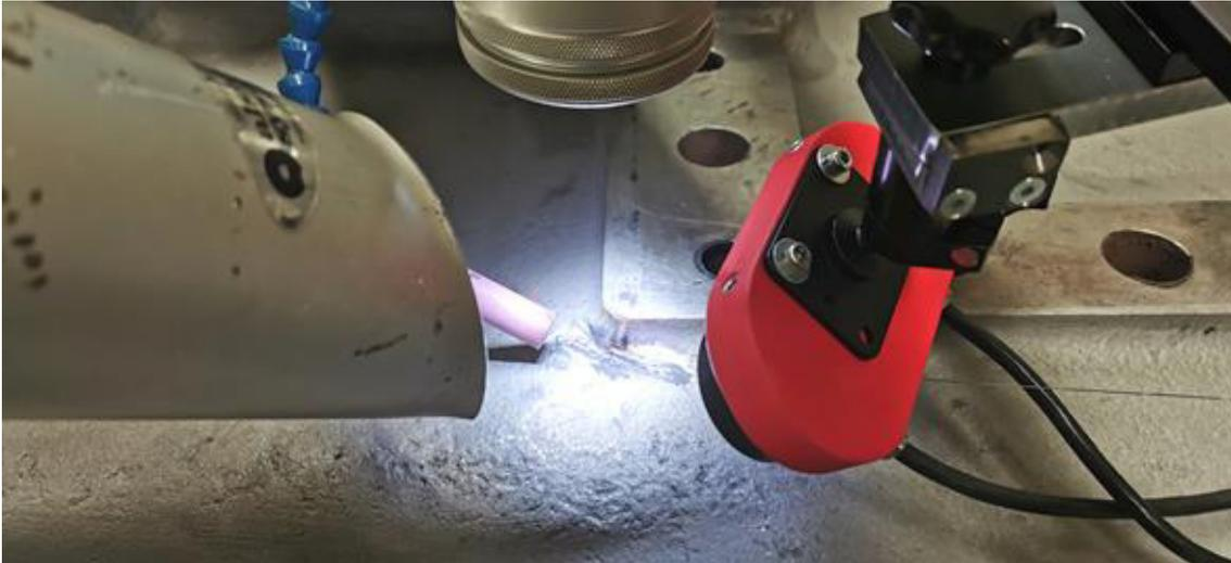
Abbildung 65. Auftragschweißung auf Eisenguss mit Nickel-Basis-Zusatzwerkstoff, Messabstand  $r = 100 \text{ mm}$ , Höhenwinkel  $\theta = 45^\circ$  (weitere Parameter im Text).
