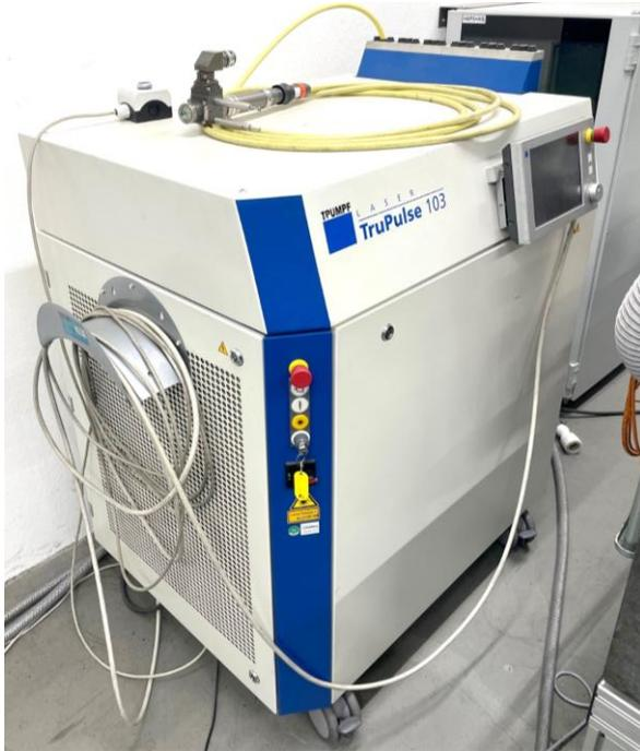
Abbildung 7. Trumpf TruPulse 103, gepulster Festkörperlaser (Laser 2).
