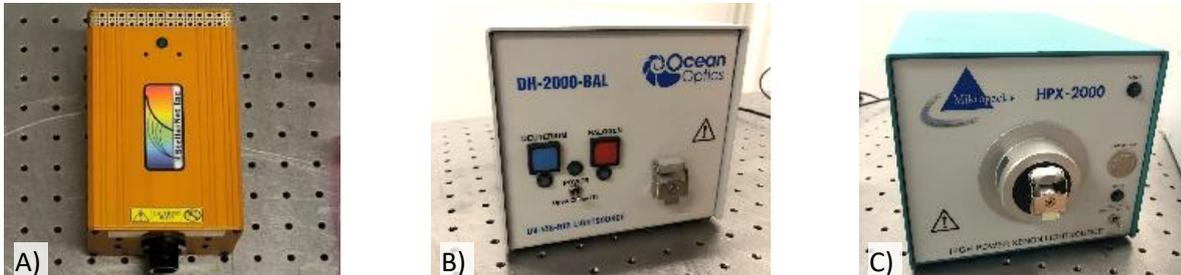
Abbildung 5: Deuterium-Strahlquelle – SL3 (A), Deuterium- und Halogen-Strahlquelle – DH-2000-BAL (B), Xenon-Strahlquelle – HPX-2000 (C).
