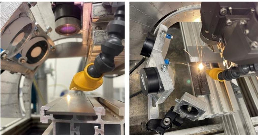
Abbildung 21. Versuch zur Validierung der Messfunktionalität der Gigahertz-Detektoren XD-45-HUV und XD-45-HB in Verbindung mit dem Optometer P 9801 (Blindschweißung an Baustahl, Parameter im Text).
