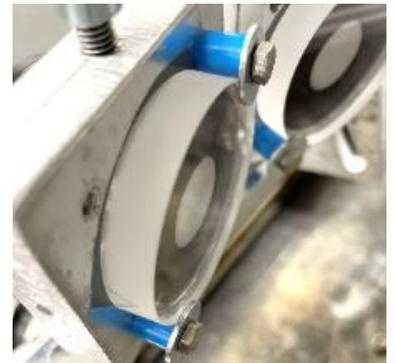
Abbildung 26. Schutzgläser mit unterschiedlicher Beschichtung zur Untersuchung der UV-Durchlässigkeit.
