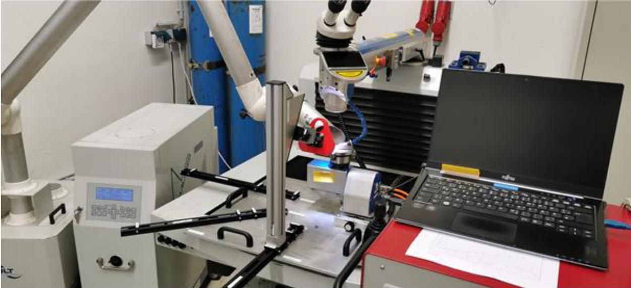
Abbildung 32. Messaufbau am Laserhandarbeitsplatz der SLV Halle GmbH.
