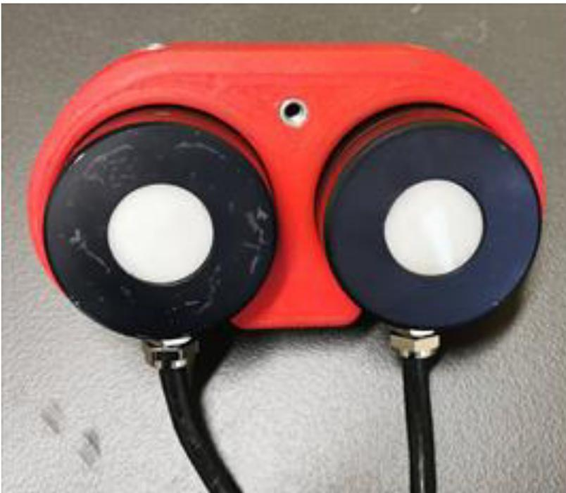
Abbildung 29. Einsatzbereiter Messsystemkopf mit montierten Sensoren XD-45-HUV und XD-45-HB von Gigahertz Optik GmbH. Das zusätzliche Gewinde oben im Bild ist für die Aufnahme der Biosensoren vorgesehen.
