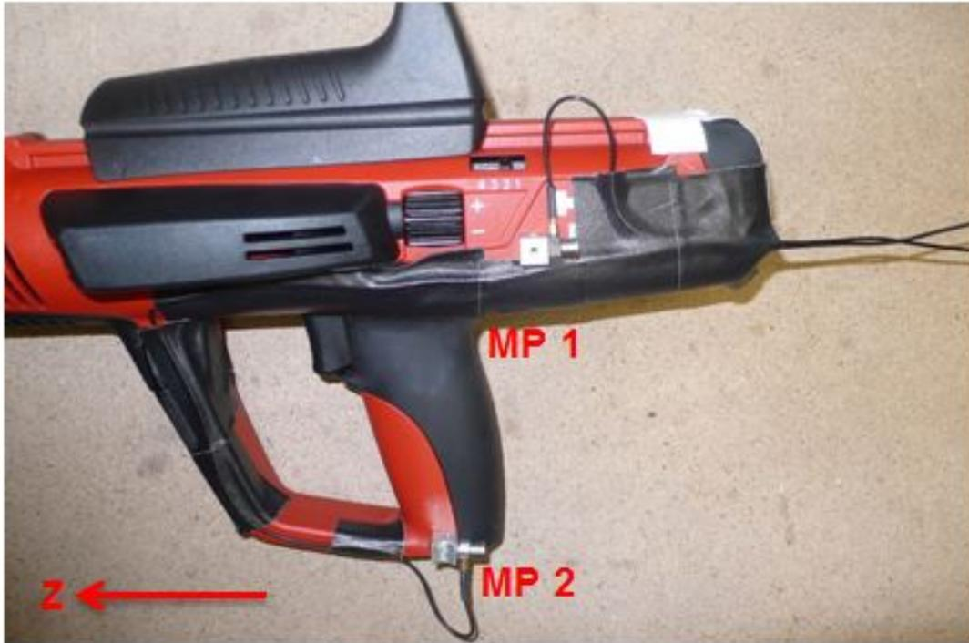
Bild 22: Anbringung der Sensoren und jeweilige Messrichtungen am Bolzensetzer
