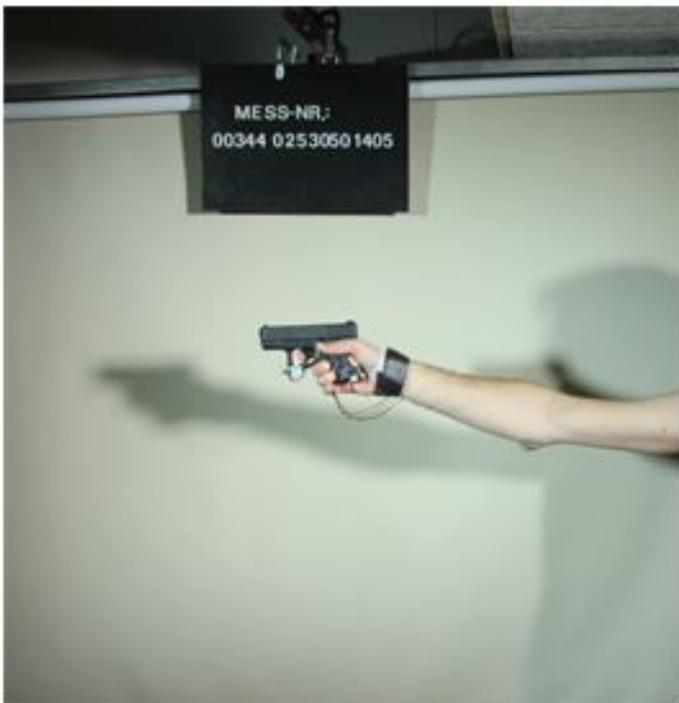
Bild 13: Versuchsdurchführung und Lage des Hand-Arm-Systems mit der Pistole
