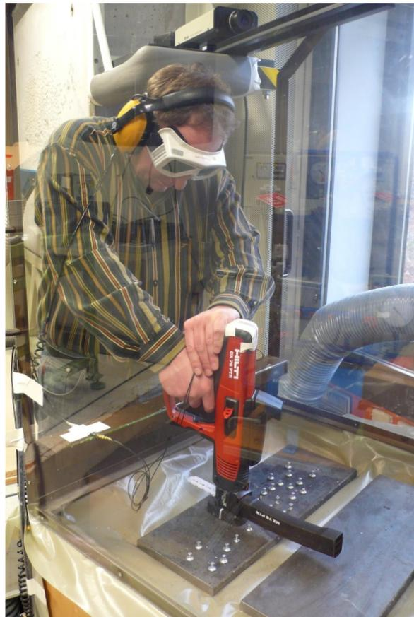
Bild 23: Versuchsdurchführung mit dem Bolzensetzer
