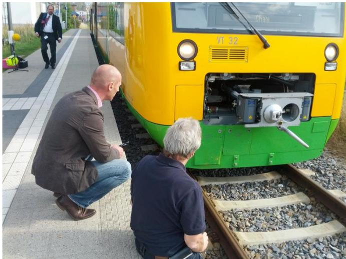
Abbildung 10. Regioshuttle RS 1 der Oberpfalzbahn (bei der DB BR 650), Einbauort des Makrofons in Kupplungs-Kammer.
