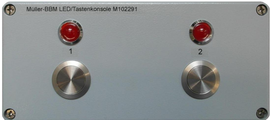
Abbildung 11. Antwortgerät (Probanden-Interface), mit dem der Proband während des Hörversuchs nach der Schallpräsentation angibt, ob er das Warnsignal im ersten oder im zweiten Darbietungsintervall gehört hat. Die Lampen leuchten während der Schalldarbietung im ersten bzw. zweiten Intervall.
