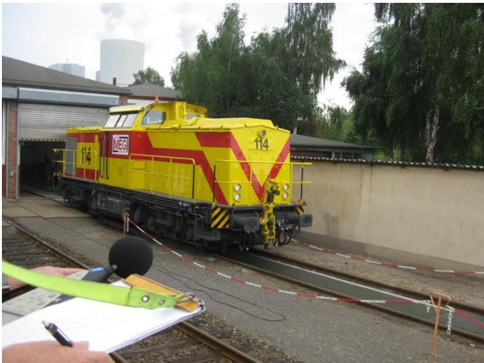
Abbildung 6. Hybridlok BR 1001 der MEG (auf Basis der früheren V 100 der DR).
