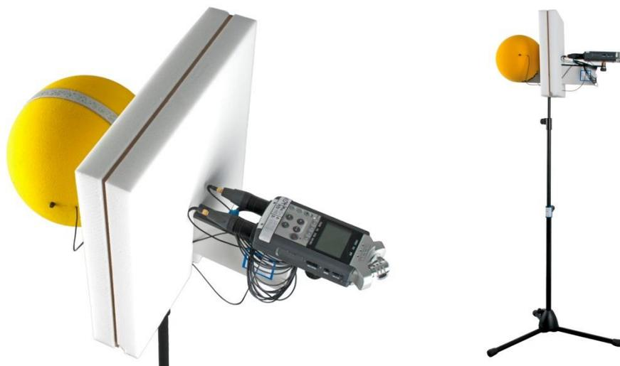
Abbildung 2. Ansicht des OSS-Aufnahmesystems auf Stativ, bestehend aus Wave-Recorder, Kopfnachbildung (gelb) aus offenporigem Schaumstoff mit akustischer Trennscheibe und zwei kalibrierten Elektret-Mikrofonen mit Kugelcharakteristik im Ohrabstand von 18 cm sowie einer rückwärtigen Reflexionsfläche (weiß) mit Absorptionsauflage aus Melaminharzschaum.
