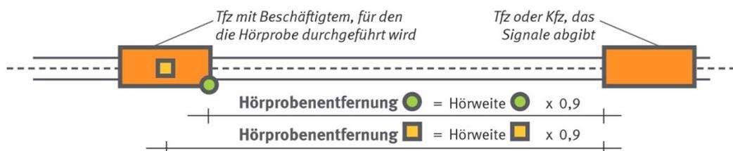
Abbildung 1. Schematische Darstellung aus [1] zur Durchführung der Hörprobe gemäß BGI/GUV-I 5147. Oben: Ermitteln der Hörweite, bei der das Warnsignal ohne Gehörschutz eben noch wahrgenommen wird. Unten: Durchführung der Hörprobe mit Gehörschutz bei 90 % der Hörweite (Hörprobenentfernung).
