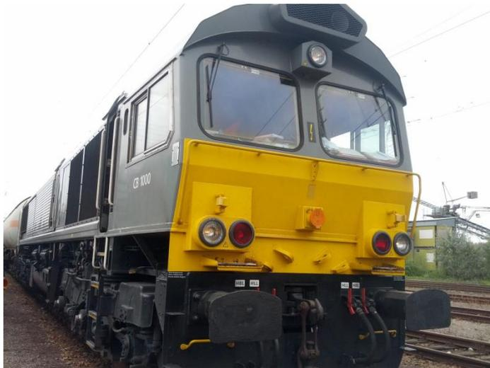
Abbildung 9. Class 66 (EMD JT42CWR) der Captrain Deutschland (bei der DB BR 247).
