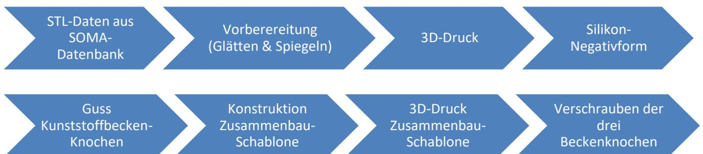
Abbildung 2: Prozess Herstellung der Kunststoffknochen
