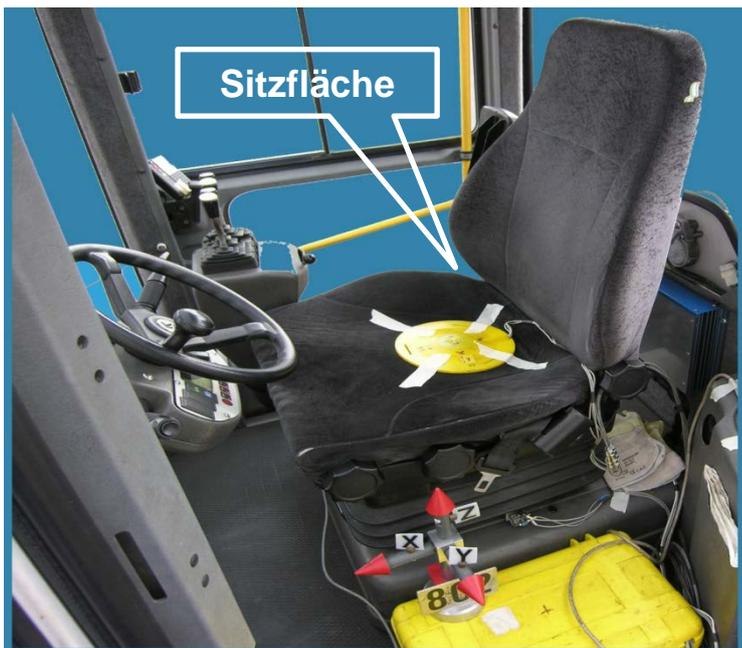
Abbildung 6: Beispiel für die Anbringung der Messsensoren für GKV
