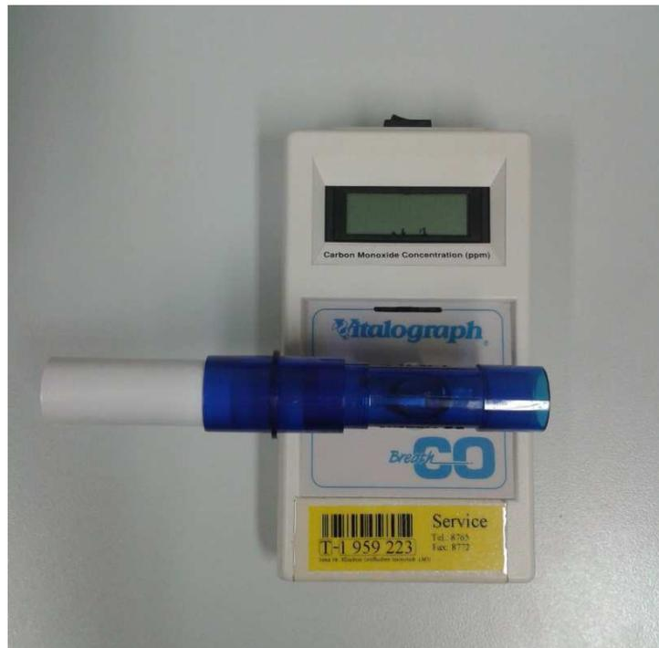
Abb. 16: Verwendetes Messgerät für das exhalierete CO (CO<sub>e</sub>).
