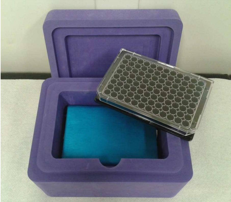
Abb. 19: Transport-Box für Mikrowell-Platten
