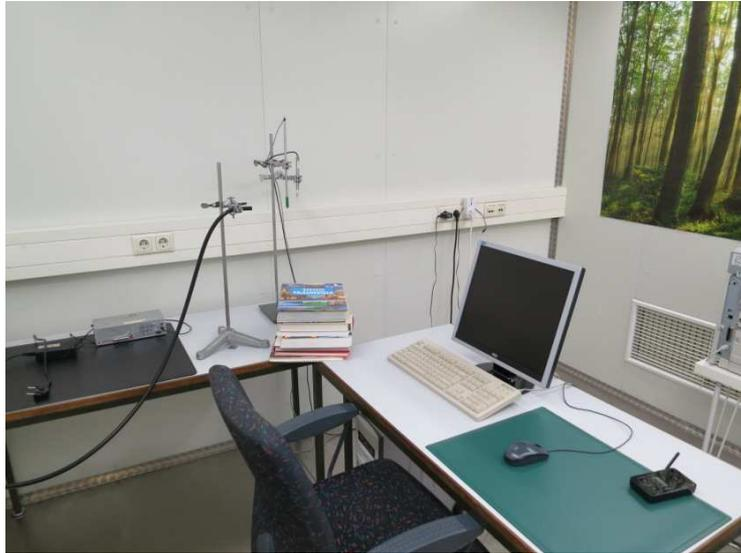
Abb. 24: Sitzplatz des Probanden mit Ansaugschlauch für die Ultrafeinpartikelmessung, Sonden für das Klimamonitoring und Messgerät für Partikel im  $\mu\text{m}$ -Bereich (Grimm 1.108)
