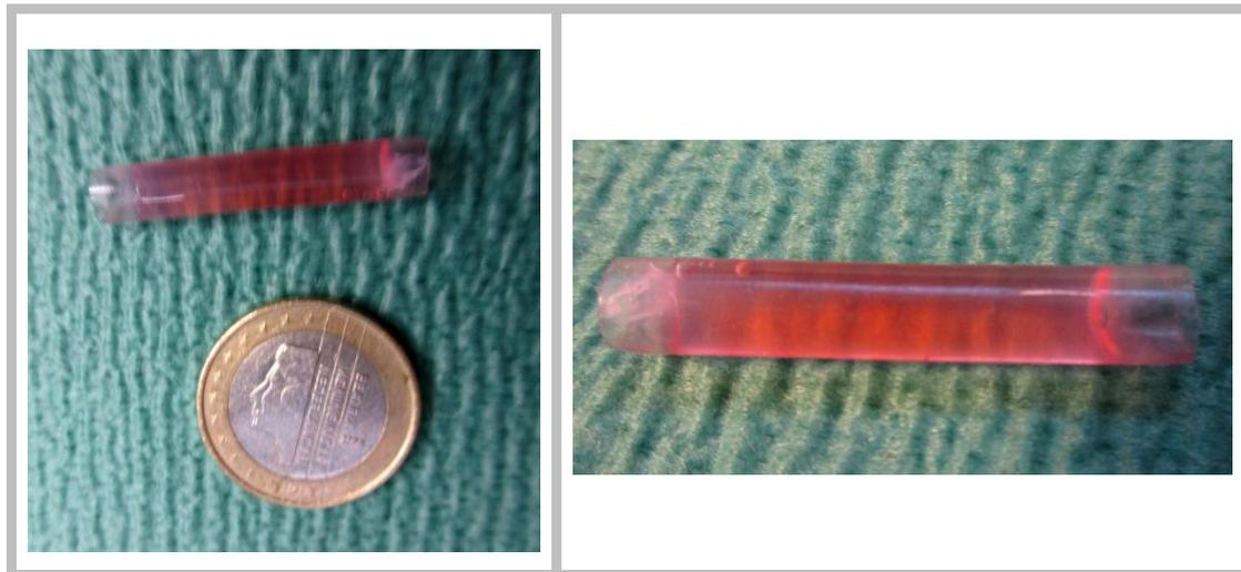
Abb. 87: Chitosan-Konduit Reaxon Nerve Guide (Medovent), gefüllt mit Cytopainter-gelabelten MSC, eingebettet in einem ausgerichteten Plasmaclot (Wippschüttler 80 rpm).
