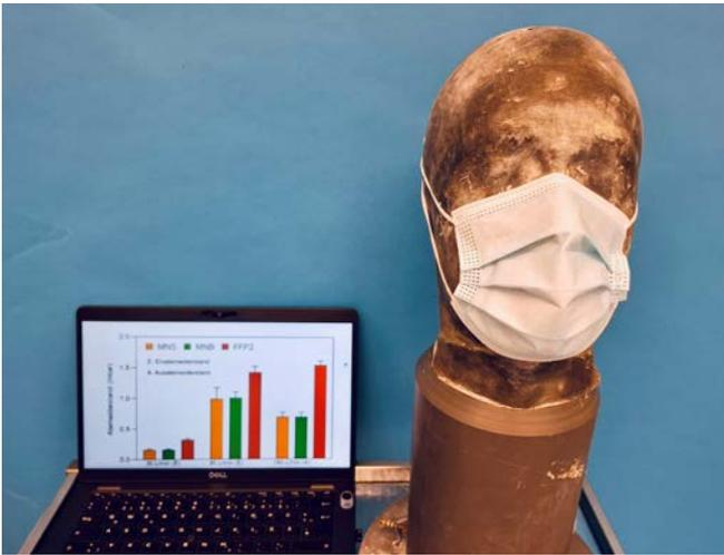
**Abb. 3** Messung des Atemwiderstandes bei zunehmenden Luftvolumina am Sheffield-Testkopf nach DIN EN 149: 2001+A1:2009.
