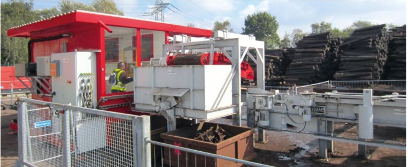
Bahnschwellen-Abplattanlage mit schutzbelüfteter Kabine
