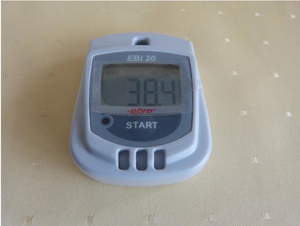
Abb. 15: Messgerät EBI 20 zur Erfassung von Temperatur und Feuchte im Saunaraum (Messbereich nur bis 60°C, also nur im unteren Saunaraum einsetzbar)
