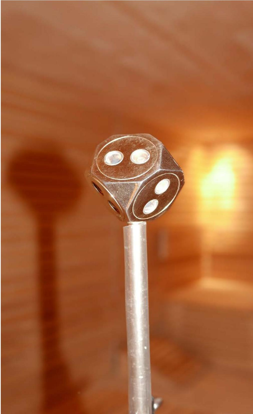
Abb. 7: Messinstrument MDRM zur Erfassung der Bestrahlungsstärke; Messgerät wurde in Raummitte aufgestellt
