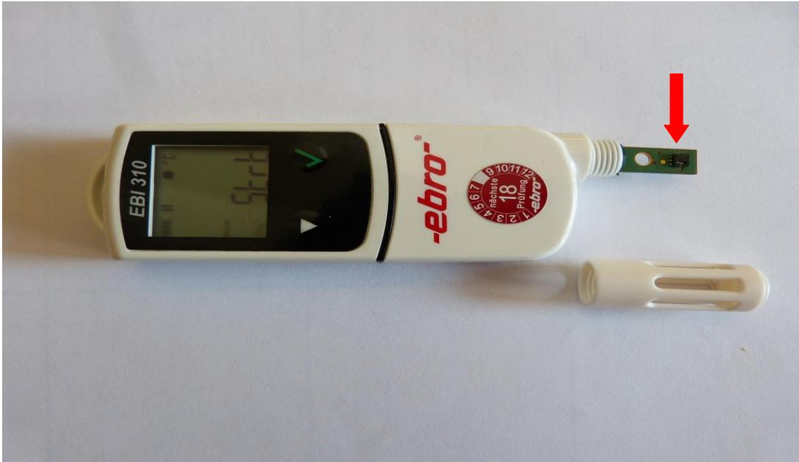
Abb. 13: EBI 310 mit abgenommenem Schutzgitter; zu sehen ist die Platine mit Fühler (schwarzes Viereck beim roten Pfeil) für Temperatur und Luftfeuchte
