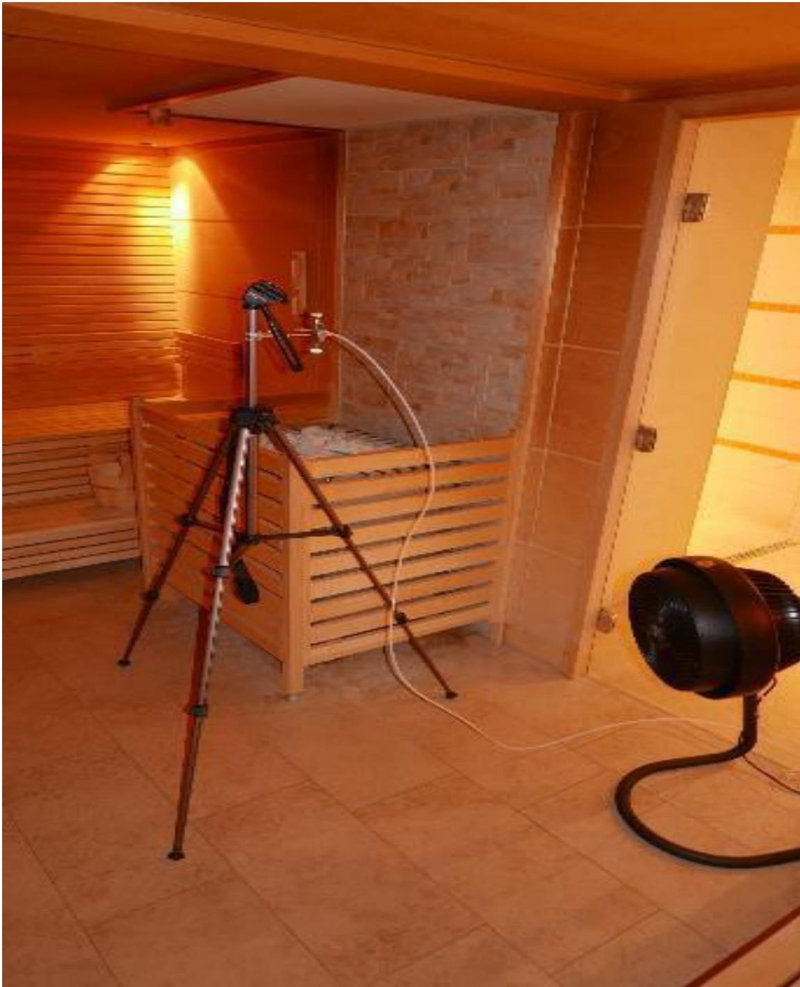
Abb. 8: Messstelle im Atembereich des Aufgießers mit Ventilator zur Verteilung des Messgases
