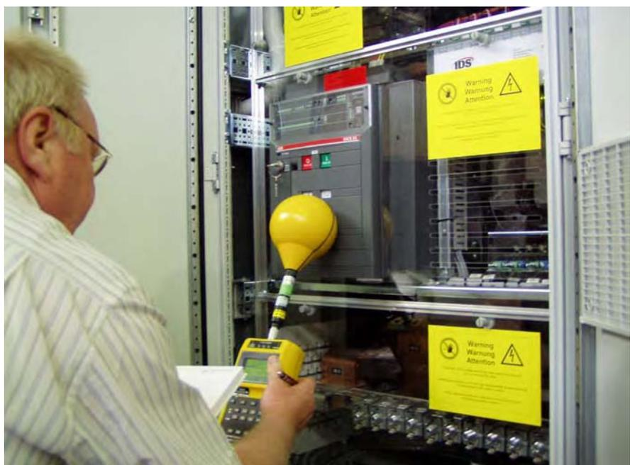
Messung magnetischer Felder in einem Schaltschrank
