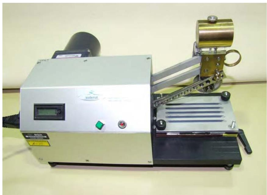
Gerät zur Prüfung der Schnittfestigkeit von Handschuhmaterialien
