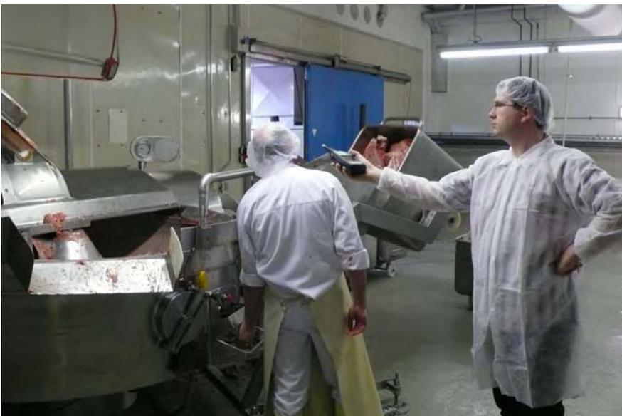
Lärmmessungen beim Ausleeren eines Kutterwagen in einem Fleischereibetrieb
