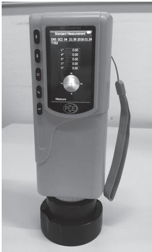
Bild 2. Colorimeter auf Filterhalterung.
