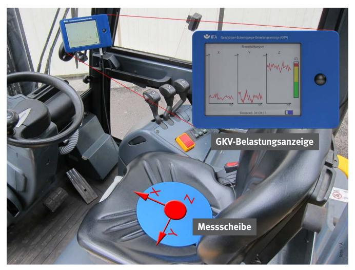
GKV-Belastungsanzeige mit Display und Messscheibe im eingebauten Zustand in einem Gabelstapler. Im Display werden frequenzbewertete Beschleunigungen in drei Raumrichtungen angezeigt; rechts zeigt der Balken den Tages-Vibrationsexpositionswert A(8) mit einer angenommenen Einwirkungsdauer von acht Stunden an.
