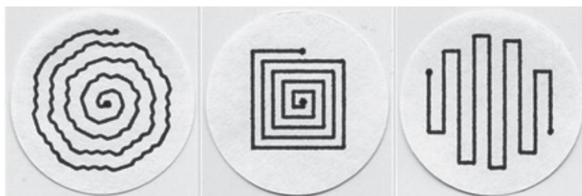
Bild 6. Programmierete und getestete Muster zur Filterbelegung.
