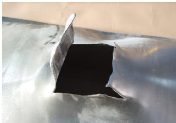
1 Schäden an den Prüfmustern: Beulung/plastische Verformung (oben links), Anriss (oben rechts), Durchschuss (unten)
