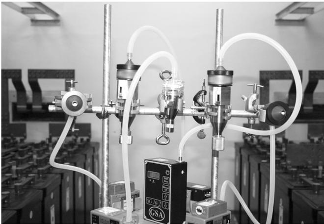
Bild 2. Versuchsaufbau aus zwei GSP-Systemen, zwei 10-l-Zyklonen und einem Zyklon GK 2.69.
