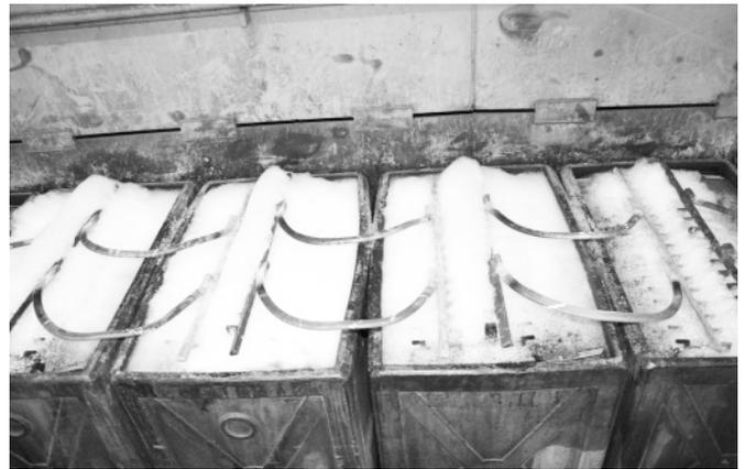
Bild 3. Tankformation von Bleiplatten mit Schaum zur Vermeidung von Schwefelsäureaerosolen.
