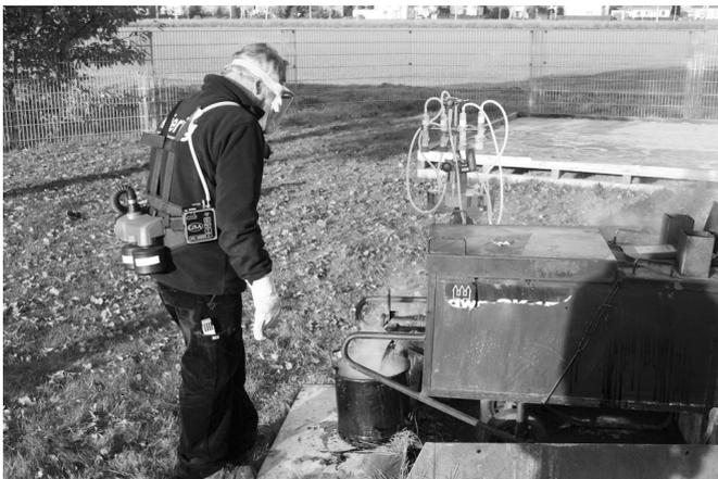
Bild 2. Ablassen der Klebemasse aus dem Teerkocher in einen Eimer und Positionierung der Probenahmesysteme am Kocher.
