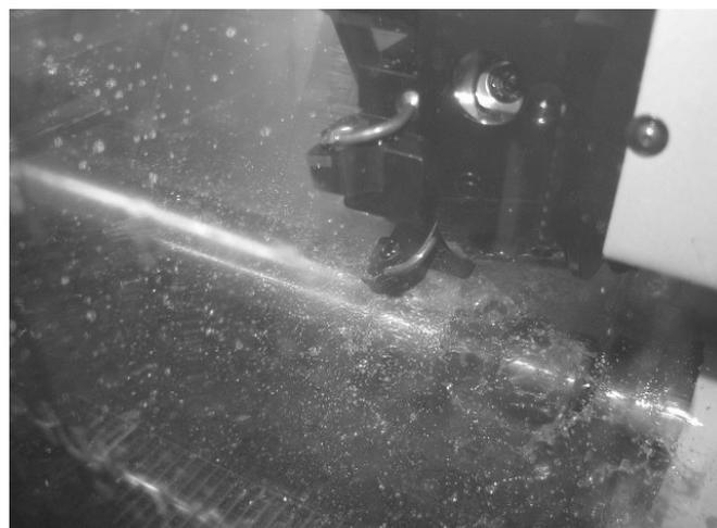
Bild 9. Maschineninnenraum bei hoher Kühlschmierstoffzufuhr.
