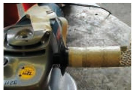
**Bild 11** Anbringung der „Finger-Matrix“ am Hilfsgriff des Winkelschleifers.
