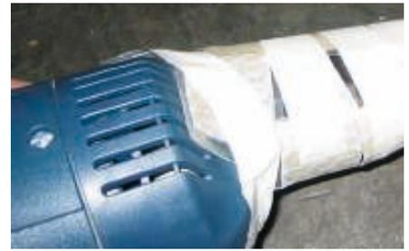
**Bild 8** Modifizierter Griff des Winkelschleifers.
