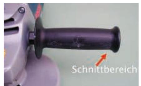
**Bild 10** Hilfsgriff am Winkelschleifer.
