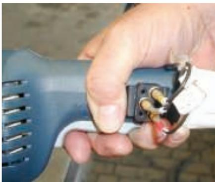
**Bild 6** Beschleunigungsaufnehmer am Hauptgriff des Winkelschleifers mit integriertem Schalter.
