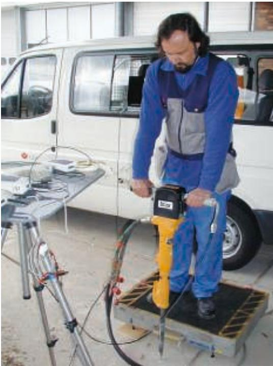
**Bild 5** Überprüfung des Messsystems mit Referenzmesskette.
