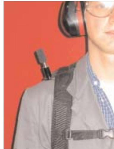
**Bild 1:** Nach ISO/CD 9612 für Dosimetermessungen vorgegebene Mikrofonposition.
