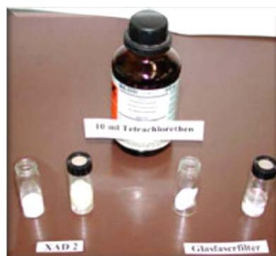
Abbildung 4: Überschichten mit 10 ml Tetrachlorethen
