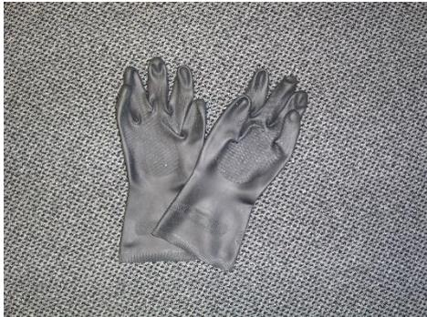
Schutzhandschuhe aus Butylkautschuk zeigen gute Beständigkeit gegenüber Estern und Ketonen und sind zusätzlich gasundurchlässig. Diese Schutzhandschuhe werden daher z. B. bei gasdichten Schutzanzügen an den Ärmeln angeschweißt. Häufig werden sie in dickeren Materialschichten hergestellt und sind recht schwer.
