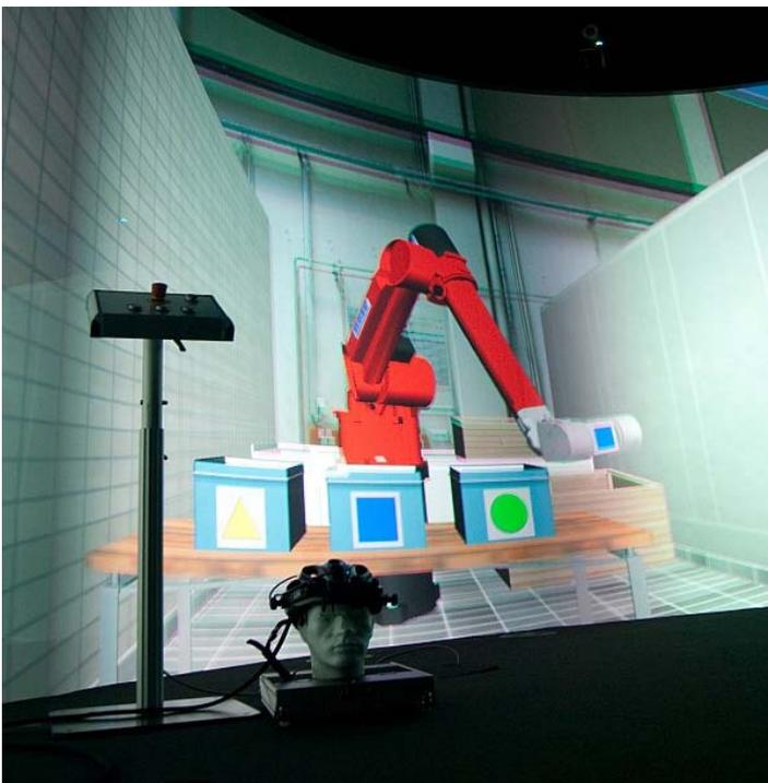
Bild 2: Projektionswand, Bedienpult und Systeme für die Blick- und Bewegungserfassung mit einem Szenario zur Mensch-Roboter-Interaktion am virtuellen Arbeitsplatz
