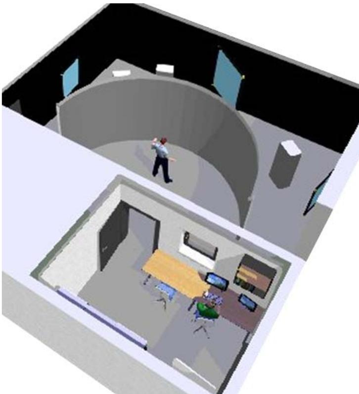
Bild 1: Skizze des SUTAVE-Labors mit VR-Interaktionsraum, Projektionswand und Rückprojektionstechnik sowie dem Vorraum zur Steuerung virtueller Arbeitsszenarien
