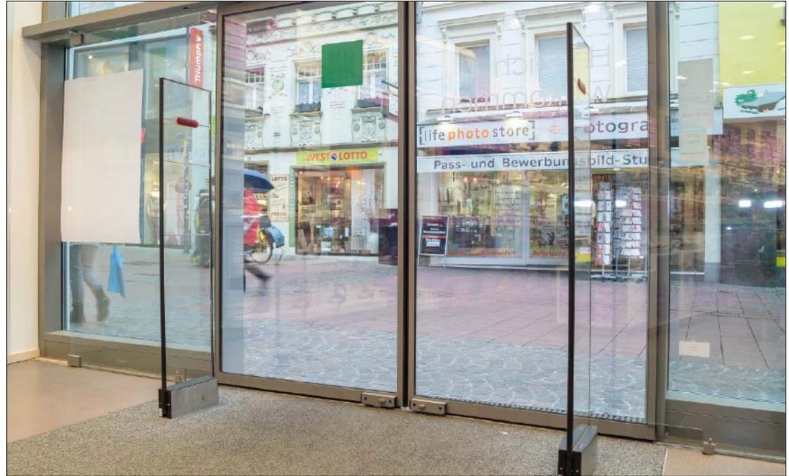
Abb. 1: Sicherungsschleuse am Ein-/Ausgang
