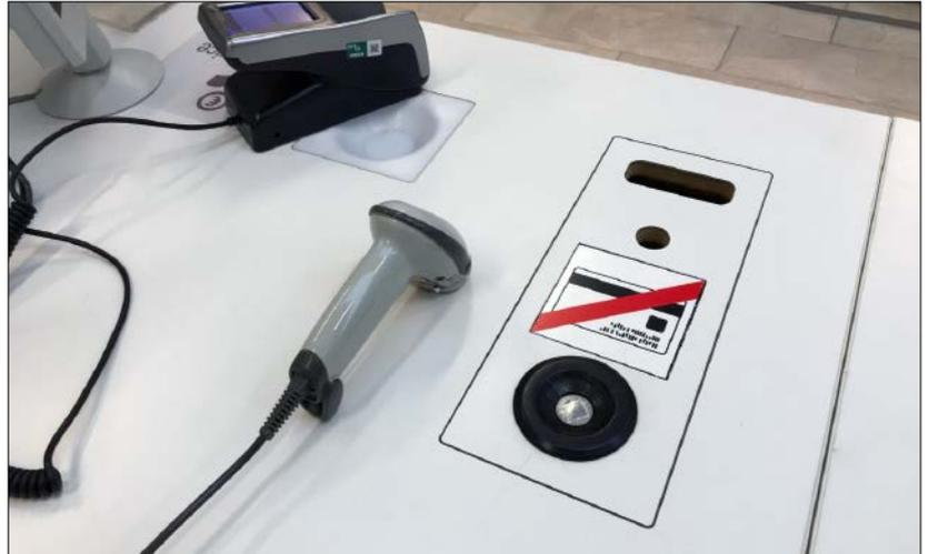
Abb. 2: Magnetlöser für Hartetiketten
