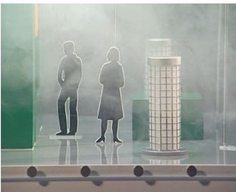
Abbildung 5: Verteilung von Gefahrstoffen im Raum bei Luftführung wie in Abbildungen 3 und 4
