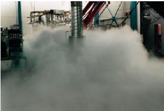
Abbildung 9: Strömungsbild an einem Quellluftdurchlass
