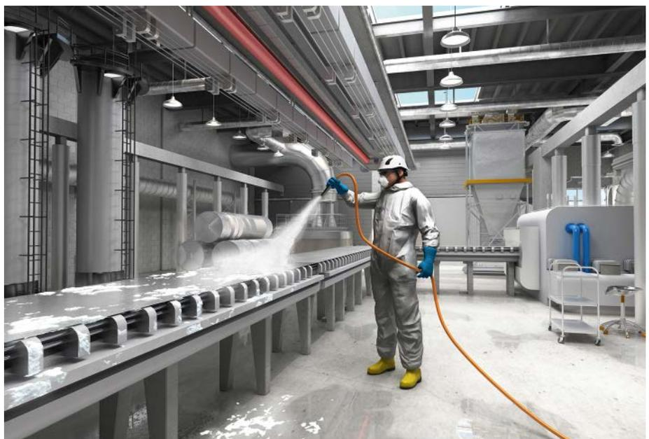
Abb. 1: Reinigung einer Bandanlage (Abb. 72 aus DGUV Regel 101-605)
