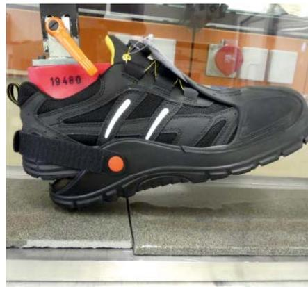
Abb. 1: Bodenschuhstester – Kombination Sicherheitsschuh + Überschuh © N. von der Bank, IFA
