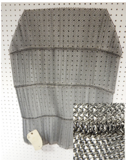
Abb. 6: Stechschutzschürze aus Spiraldraht. Um das deutlich zu erkennende Bestreben des Materials sich zusammenzukrempeln zu verhindern, fügte man bei diesem schon weiterentwickelten Modell Querstege ein. © F.-J. Morvilius
