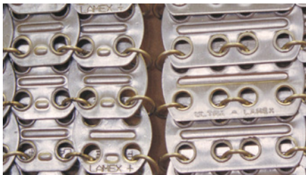
Abb. 11: Zwei moderne Schuppenplättchengewebe bieten eine sehr gut geschlossene Oberfläche und weisen eine sehr sorgfältige Verarbeitung auf. Bei insgesamt sehr guter Beweglichkeit erreichen sie allerdings nicht die Flexibilität der Ringgeflechte.
