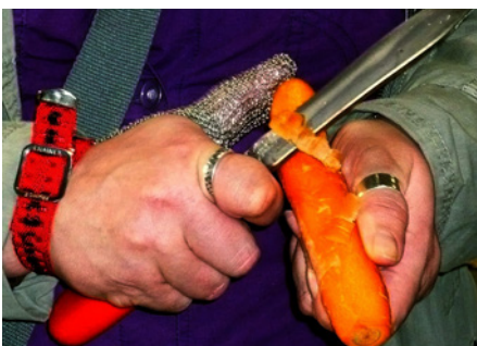
Abb. 13: Anwendungsbeispiel eines Schnittschutzdaumens, der ursprünglich in Frankreich für spezielle tierärztliche Aufgaben entwickelt wurde und durch die Initiative deutscher Hersteller nun auch in Küchenbetrieben und der Kunststoffindustrie Eingang fand. © F.-G. Winkler
