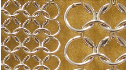
Abb. 10: Zwei moderne Metallringgeflechte aus rostfreien und – auf Wunsch – detektierbarem Edelstahl, weisen bei Markenherstellern fest geschlossene und sauber polierte Schweißnähte auf und erfüllen so problemlos die Vorgaben der Prüfnormen.
