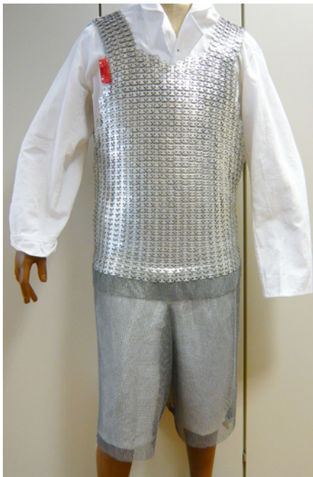
Abb. 12: Eine aktuelle Stechschutzausrüstung, bei der die aktuellen Stechschutzmateriale miteinander kombiniert wurden und die praktisch vom Hals bis unterhalb des Knies schützt.
