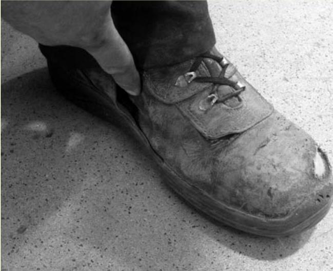
Abb. 4: Aufgerissene Nähte, Feuchtigkeit kann eindringen, Gefahr des Hängenbleibens Eintritt von Fremdkörpern möglich etc.
