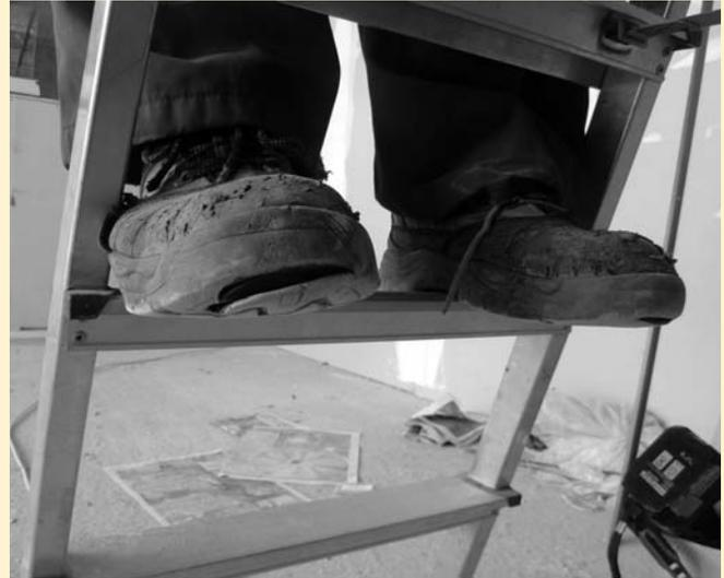
Abb. 5: Sohle defekt, Stahleinlage freiliegend, Feuchtigkeit kann eindringen, Gefahr des Hängenbleibens, Eintritt von Fremdkörpern möglich etc.
