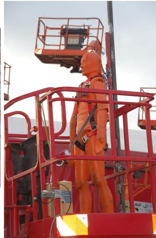
Verwendete PSAgA – mitlaufendes Auffanggerät einschl. beweglicher Führung
