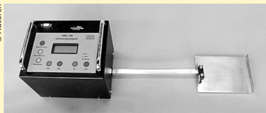
Abb. 5: Gleitmessgerät GMG 200
