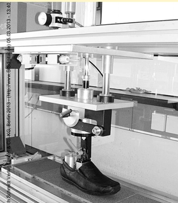
Abb. 3: Boden-Schuh-Testgerät
