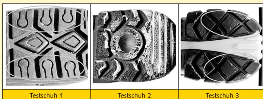
Abb. 6: Präparierte Laufsohlen nach Prüfung auf Boden-Schuh-Testgerät; Prüfbelag Feinsteinzeug
