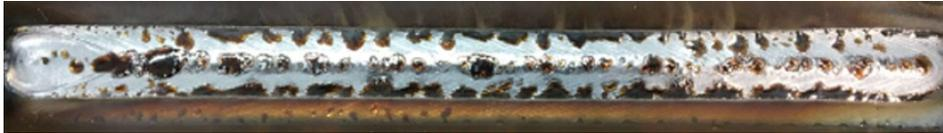
3-lagige Kehlnaht, geschweißt mit einem G 4Si1 Ø1,2 mm ohne Analyseneinschränkung, Schutzgas M21-ArC-18, zeigt ein hohes Aufkommen an Oxiden/Silikaten auf der Oberfläche, schwer entfernbar.
