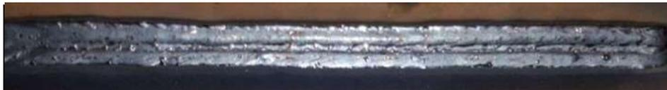
3-lagige Kehlnaht, geschweißt mit einem G 3Si1 Ø1,2 mm, Schutzgas M21-ArC-18, zeigt ein hohes Aufkommen an Oxiden/Silikaten auf der Oberfläche, schwer entfernbar.
