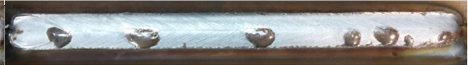
3-lagige Kehlnaht, geschweißt mit einem G 4Si1 Ø1,2 mm mit besonderer Analyseneinschränkung (ESAB Purus 46), Schutzgas M21-ArC-18, zeigt ein günstigeres Aufkommen an Oxiden/Silikaten auf der Oberfläche, leichter entfernbar.
