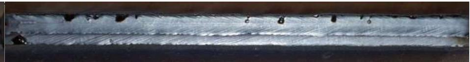
3-lagige Kehlnaht, geschweißt mit einem G 3Si1 Ø1,2 mm mit besonderer Analyseneinschränkung (ESAB Purus 42 CF), Schutzgas M20-ArC-8, zeigt ein günstigeres Aufkommen an Oxiden/Silikaten auf der Oberfläche, leichter entfernbar.
