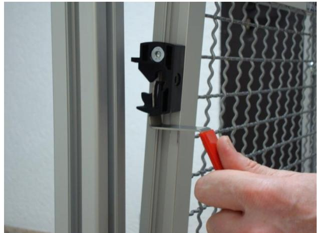
**Bild 2:** Spezialwerkzeug in gesteckter Position zum Lösen eines Zaunelements - Eine Lösung von vielen.
