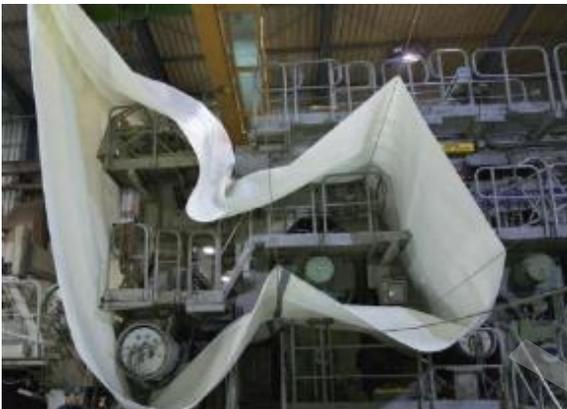
Abbildung 41 – Wechsel der Bespannung
