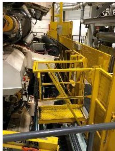
Abbildung 40 – Hubarbeitsbühne mit ausgefahrener Walzenwechselbühne
