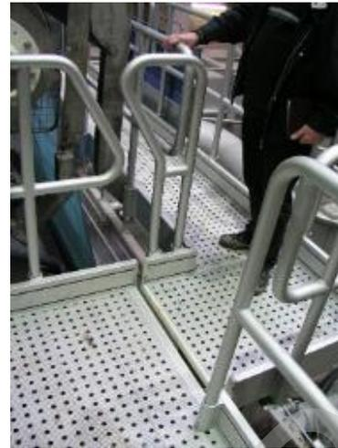
Abbildung 43 – Geeignete Öffnung an den Geländersegmenten und Durchführspalt im Laufsteg
