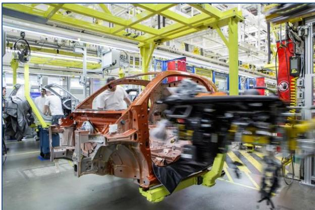
**Bild 1:** Ergonomisch gestalteter Arbeitsplatz bei der Cockpit-Montage
