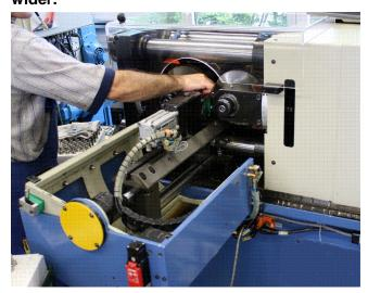
**Bild 1:** Transparente trennende Schutzeinrichtung an der Einlegestelle einer Rollwalzmaschine mit der erforderlichen kleinstmöglichen Öffnung
