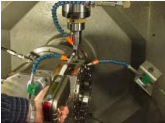
**Bild 7: Bestimmung der CO-Konzentration mit direktanzeigendem Messgerät**
