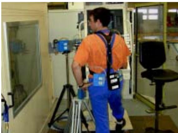
**Bild 8: Expositionsmessungen personengetragen und am Bedienpult**
