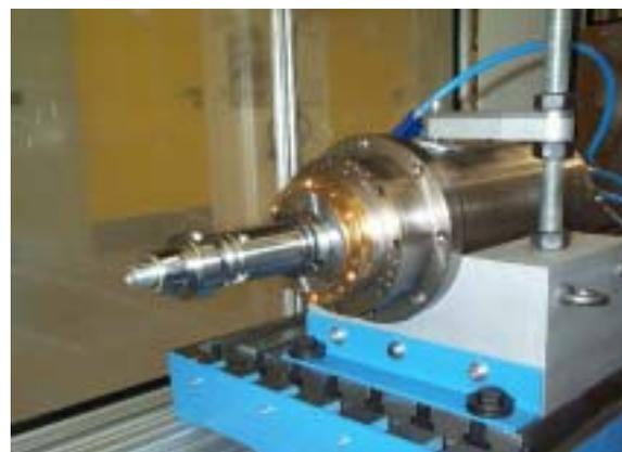
**Bild 1: Spindelprüfstand mit HSC-Motorspindel
