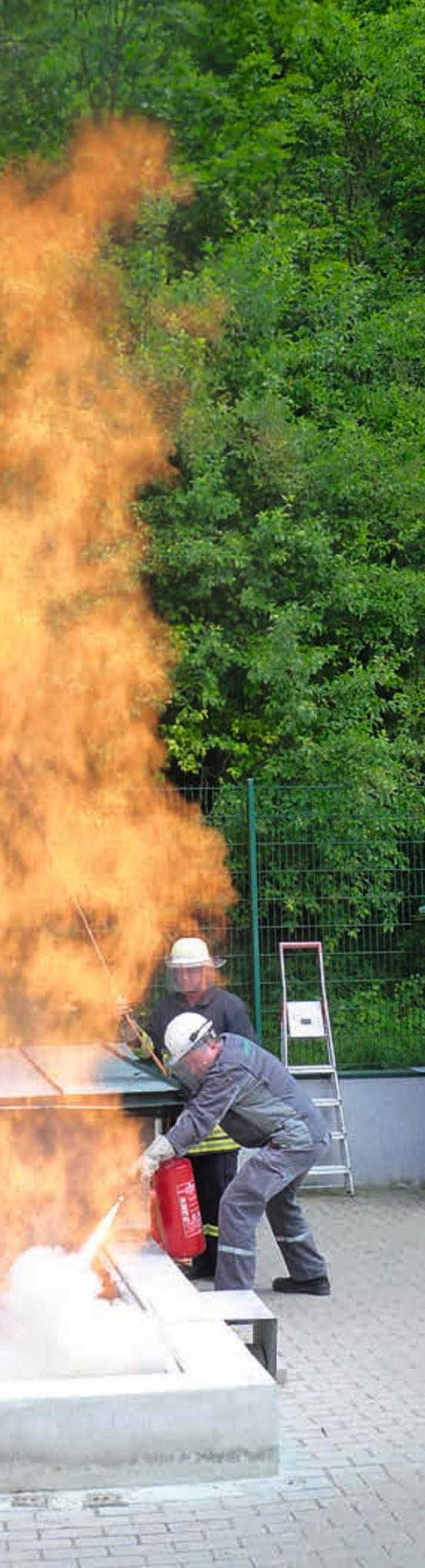
zeichnung 55A 233B C oder 233B C; diese Zahlen-Buchstaben-Kombination ist auf dem Feuerlöscher angebracht; entspricht der Kennzeichnung nach ASR A2.2). Die Füllmenge muss mindestens 6 kg betragen, empfohlen werden 12 kg. Die Eignung der Feuerlöscher konnte im Rahmen praktischer Versuche auf einer Brandsimulationsanlage bestätigt werden.
