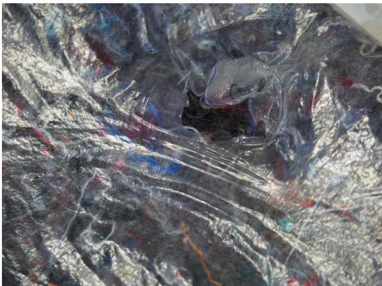
**Bild 6:** Mögliches Schadensbild – Risse und Löcher im Prüfmuster
